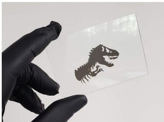
Nanotinta aplicada sobre vidro (com auxílio de aerógrafo, stencil e superfície aquecida)
