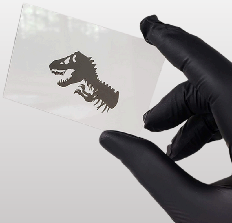
Nanotinta aplicada sobre vidro (com auxílio de aerógrafo, stencil e superfície aquecida)
